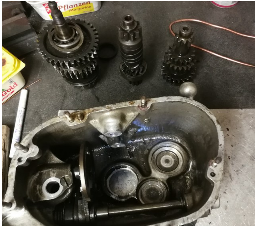
Abbildung 13: alle Antriebswellen ausgebaut
