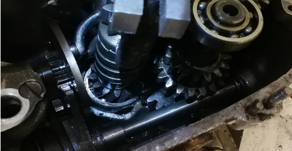
Abbildung 8: Lager von Eingangswelle rutscht bis Zahnrad von Nebenwelle
