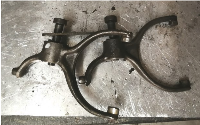
Abbildung 9: Schaltgabeln mit Farbmarkierung und Sicherungsblech
