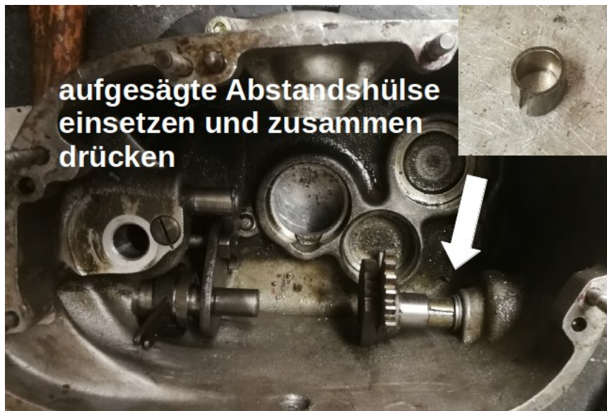
Abbildung 16: Abstandshülse zwischen Zahnsegment und Unterlegscheiben
