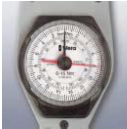
Abb. 25 : Integrierter Schleppzeiger auf gut ablesbarer Skala zur leichten Bestimmung des erreichten Drehmomentwerts
