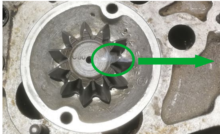
Abbildung 29: Position Schmierölbohrung in Ruhelage
