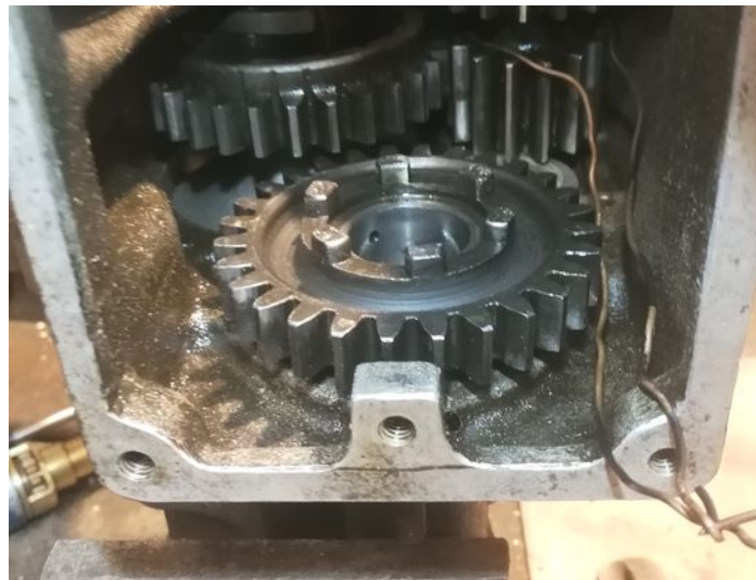
Abbildung 31: 1.Gangrad auf Ausgangslager
