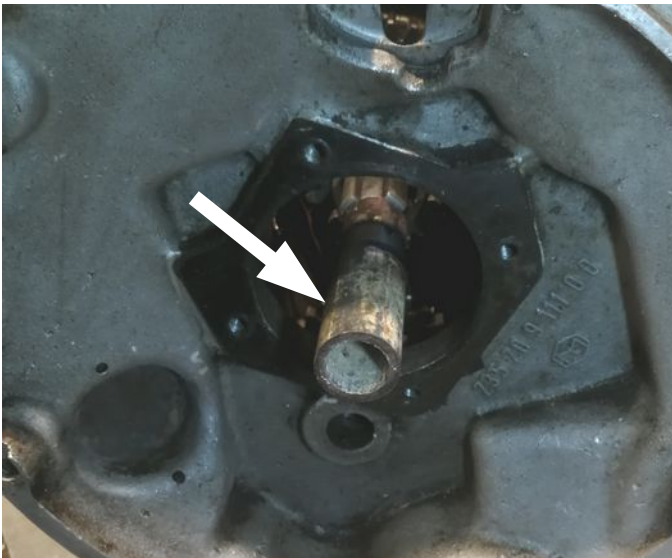
Abbildung 34: Abstützdorn für Ausgangswelle zur Werkbank
