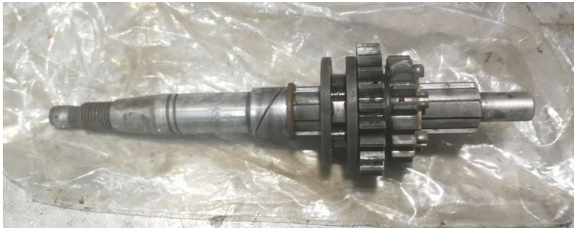
Abbildung 32: vormontierte & heruntergekühlte Ausgangswelle
