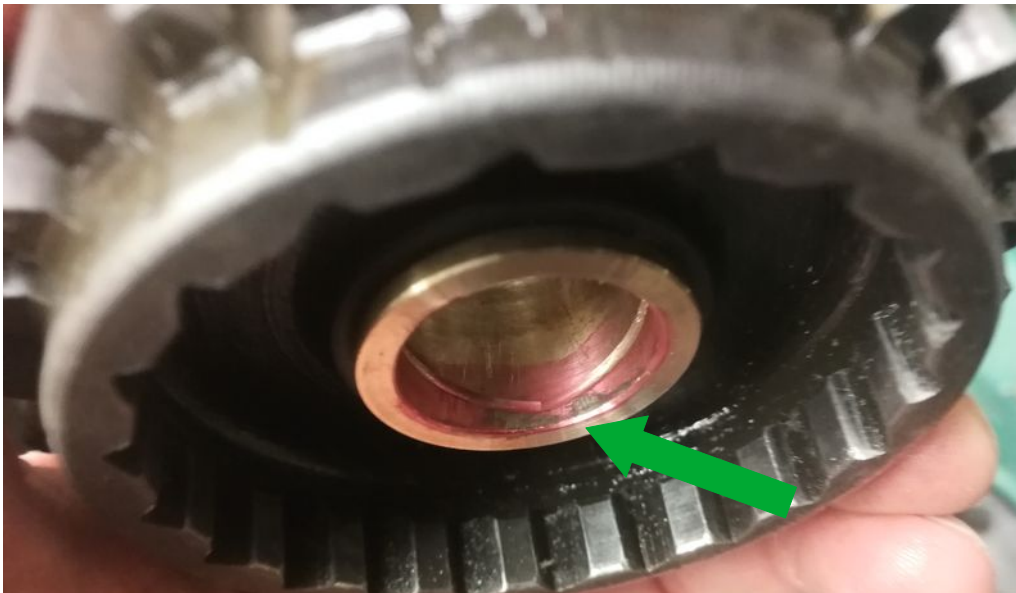
Abbildung 24: Farbmarkierung & Abtrag zur Verdeutlichung von Schleifspuren an Lagerbuchse
