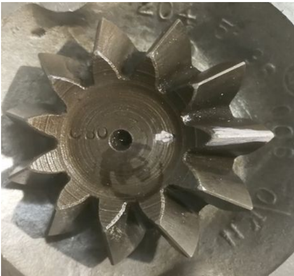
Abbildung 25: Pfeilmarkierung wo sich Schmierölbohrung befindet
