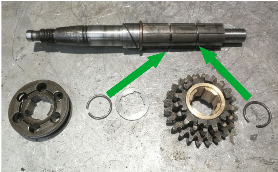
Abbildung 16: Ausgangswelle: Schiebemuffe 1./2.-Gang (Vertiefung; Anordnung der Sicherungsringe, Anlaufscheibe und 2./3.Gangrad
