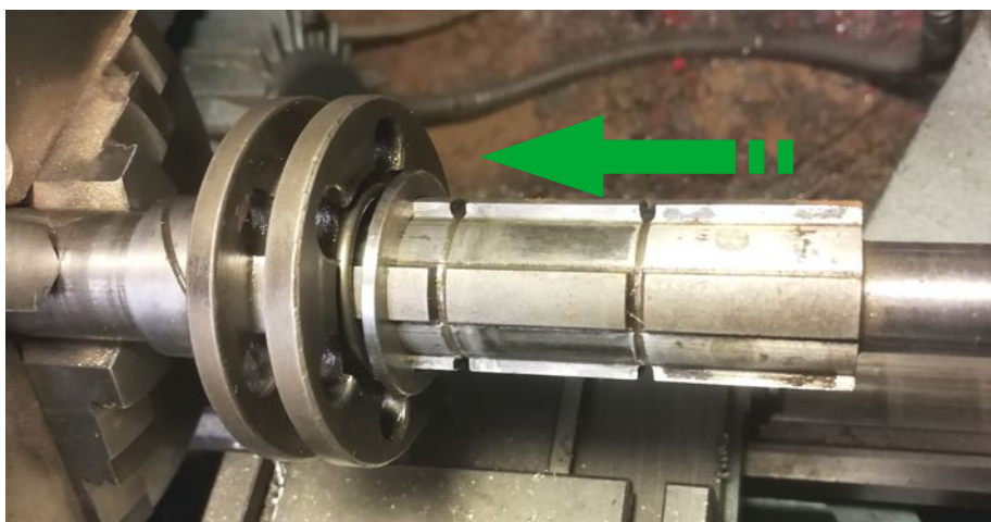
Abbildung 20: Schiebemuffe, Sicherungsring & Anlaufscheibe (Sicherungsring beim Aufschieben durch Kabelbinder vor Hineinspringen bewahren)
