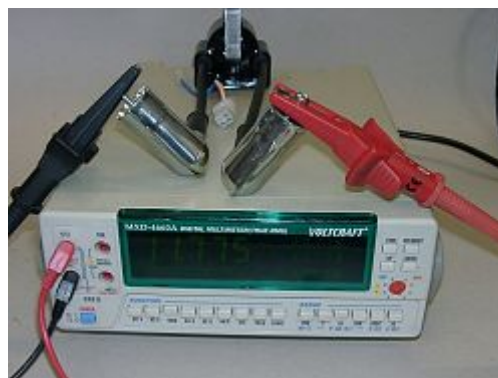
Meßgerät auf eine Anzeige zwischen 5-20 kOhm einstellen. (Für Vergrößerung bitte Bild anklicken!)
