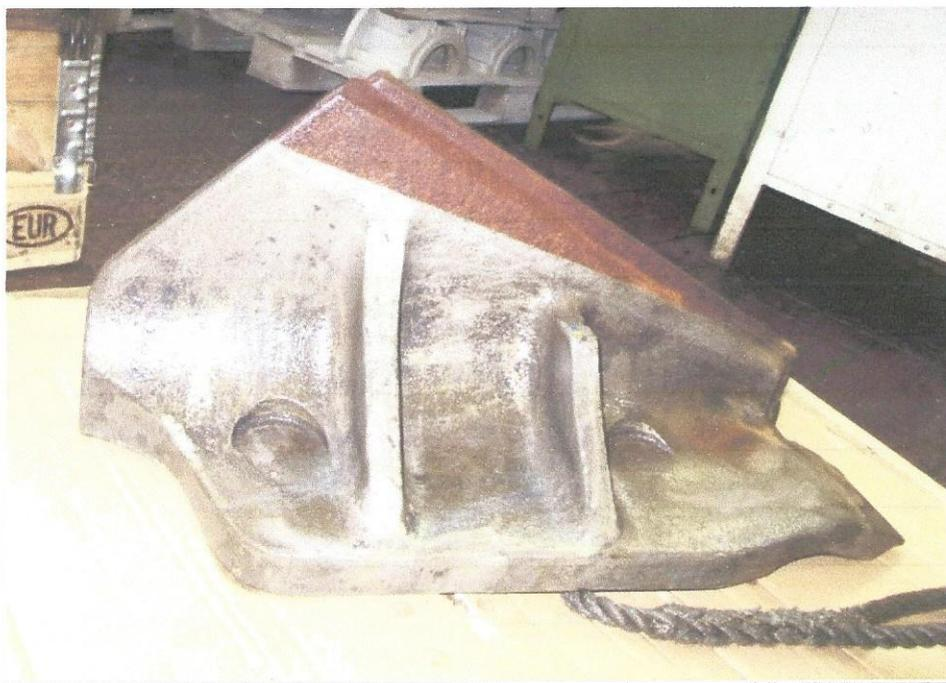
Abb. 1 b: GS16MN5N-Formteile nach der Entrostung
