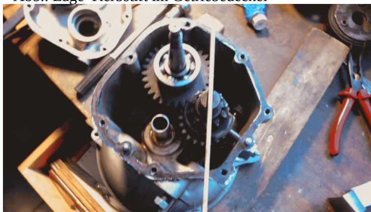
Abb.: Hauptwellenschlitz Lage im Gehäuse
