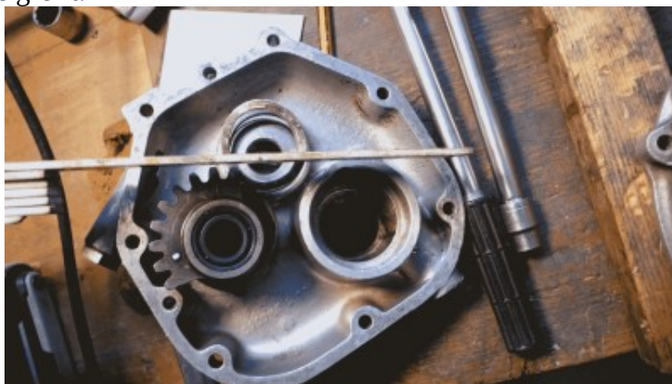
Abb.: Lage Kerbstift im Getriebedeckel
