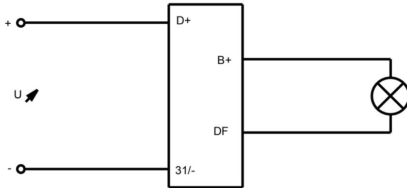
Test der Sperrfunktion der Rückstromdiode.
